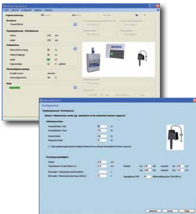
Einstelldialog Laborabzugsregelung mit Einströmsensor
