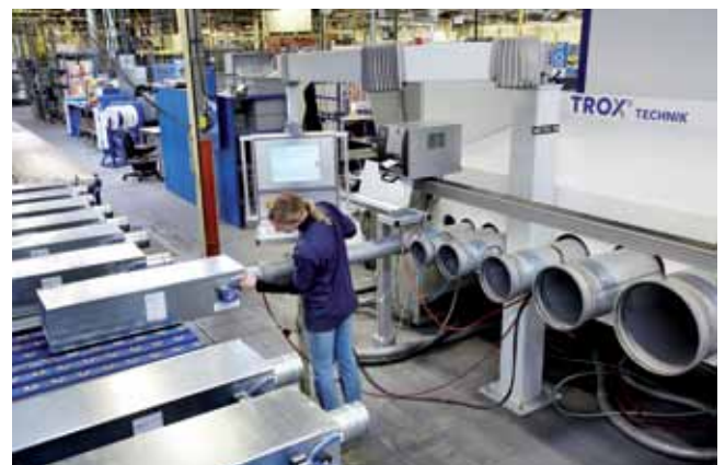
Herstellung, Überprüfung und Justage von Volumenstromreglern im Werk
